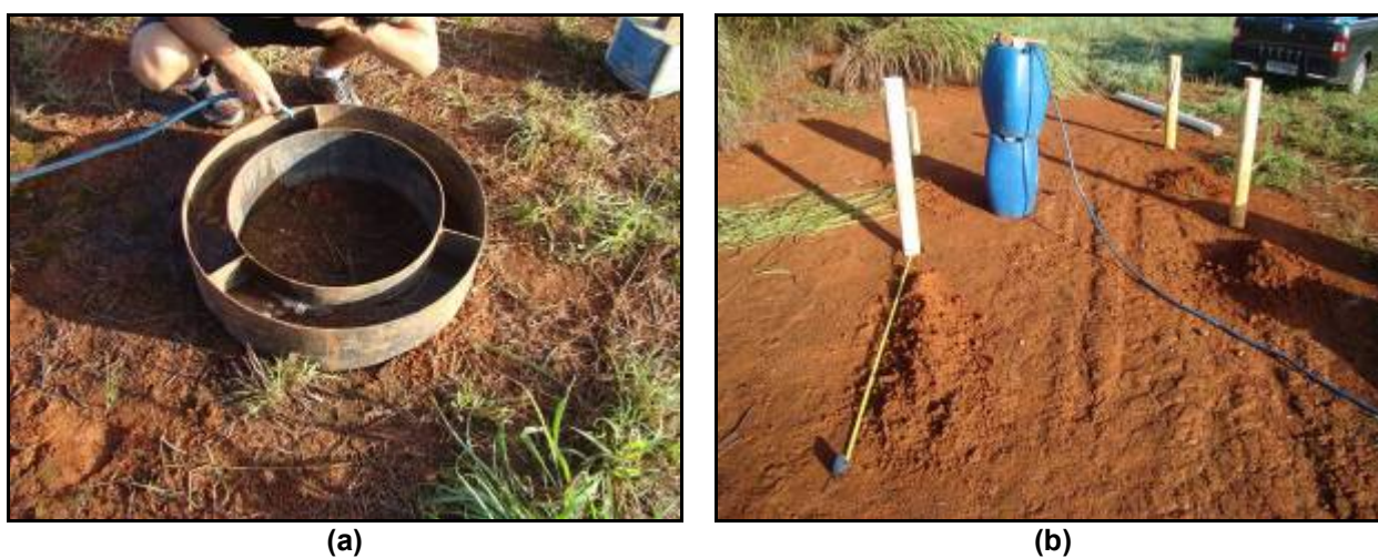
Figura 35 - (a) Ensaio de permeabilidade superficial no ponto 01 e (b) praça de ensaio de infiltração no ponto 01.
