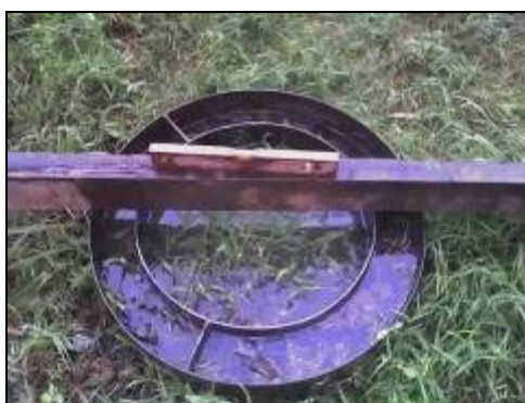
Figura 39 - Ensaio de permeabilidade superficial realizado no ponto 05.
