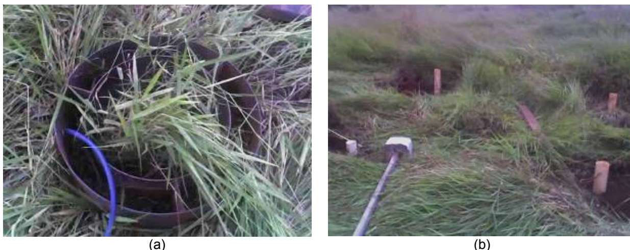
Figura 38 – (a) Ensaio de permeabilidade superficial no ponto 04 e (b) Praça de ensaio de infiltração no ponto 04.
