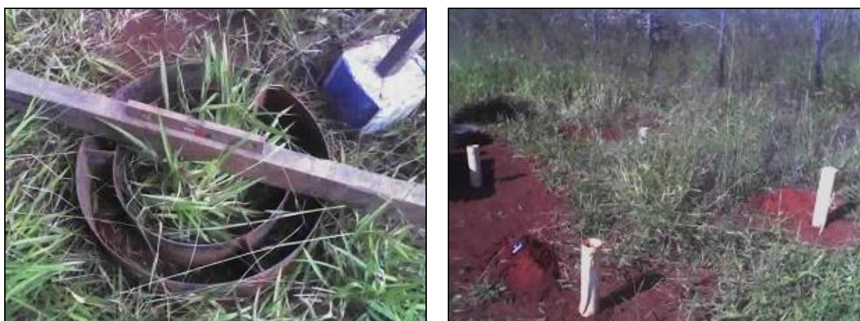
Figura 37 – (a) Ensaio de permeabilidade superficial no ponto 03 e (b) Praça de ensaio de infiltração no ponto 3.
