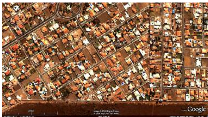
Figura 164 - Ruas sem saída (em cul-de-sac) no Setor Grande Colorado. (Fonte Google Earth).
